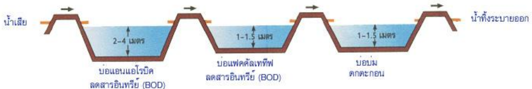
ตัวอย่างการวางบ่อของระบบบ่อบำบัดเสถียร (Stabilization Pond)
